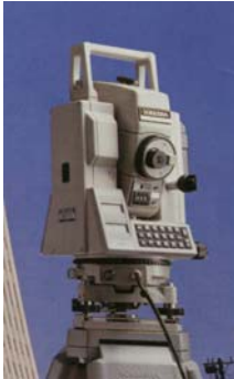
Γεωδαιτικός Σταθμός (Total Station) SOKKISHA SET3 (SN 101569)
